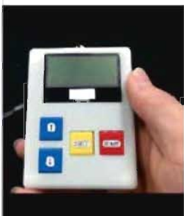
「酸素ポンプの残量計の試作」 残量計の外観と製作した基板
