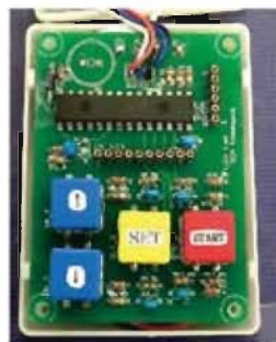
「酸素ポンプの残量計の試作」 残量計の外観と製作した基板
